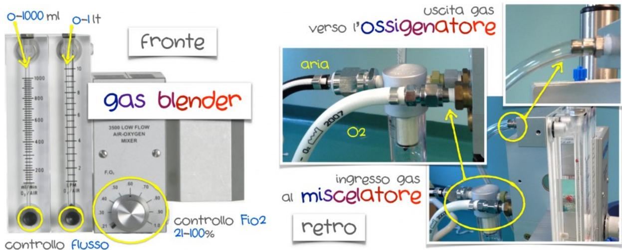
*Figura 9. Gas blender o miscelatore dei gas, a sinistra visione frontale con manopole di controllo, a destra veduta posteriore con connessioni ai gas freschi in ingresso ed in uscita verso l'ossigenatore.*
