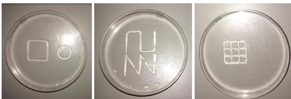
Figura 4.1: Verifica **stampabilità dell'alginato**: (a) cerchio di diametro pari a 10 mm e quadrato di lato pari a 10 mm, (b) tre strisce di lunghezza pari a 15 mm aventi congiunzione sia lineare che obliqua, (c) griglia di ampiezza lato e celle pari a 15x15 mm e 5x5 mm rispettivamente. La quantità equivalente di filamento estrusa è stata fissata a 0.2 mm per il quadrato, circonferenza e strisce mentre per la griglia a 0.1 mm. La velocità è stata fissata a 90 mm/min per tutte le geometrie.
