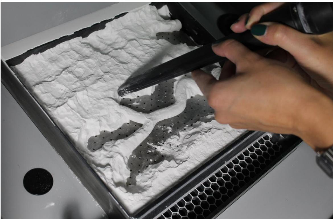
**Figura 5.5:** visualizzazione di come viene aspirata la polvere per riuscire a togliere i provini dalla stampante
