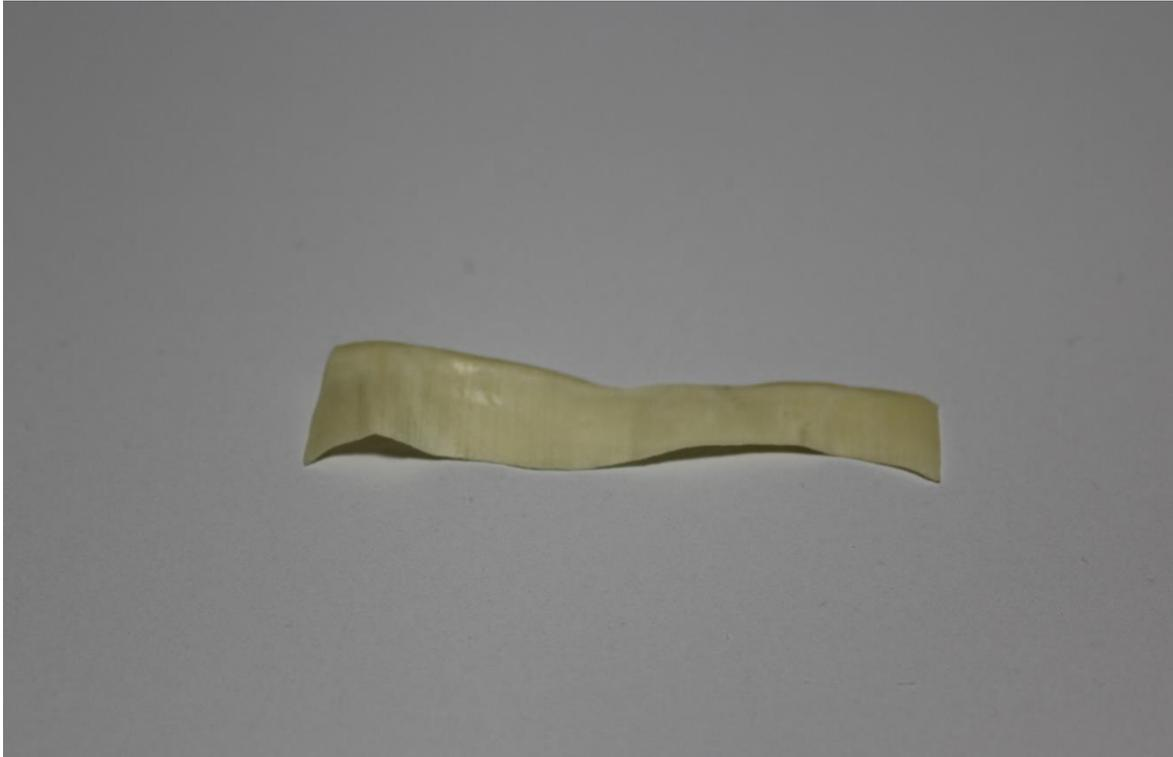
*Figura 5.11: frammento di lattice pulito e tagliato per effettuare le misurazioni dello spessore*
