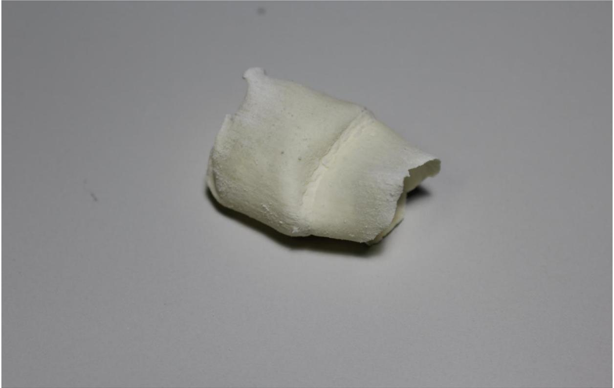
**Figura 5.9:** lattice estratto dal provino, deve essere lavato per togliere la polvere di gesso superflua e tagliato per effettuare il test
