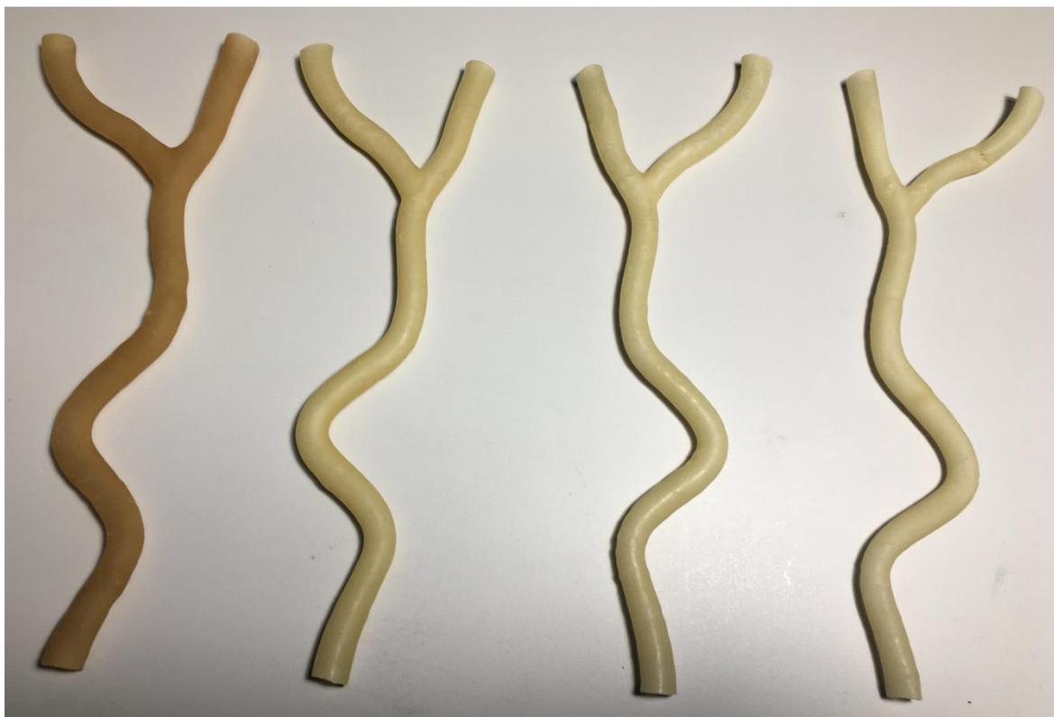
**Figura 7.10:** modelli in lattice con spessori via via decrescenti da sinistra verso destra: nel primo da sinistra è stato effettuato un dipping con 5 immersioni nel lattice, nel secondo 4 immersioni, nel terzo 3 immersioni e nell'ultimo due immersioni.
