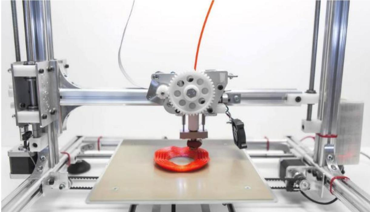
**Figura 2.2:** esempio di stampante 3D di tipo FDM all’opera
