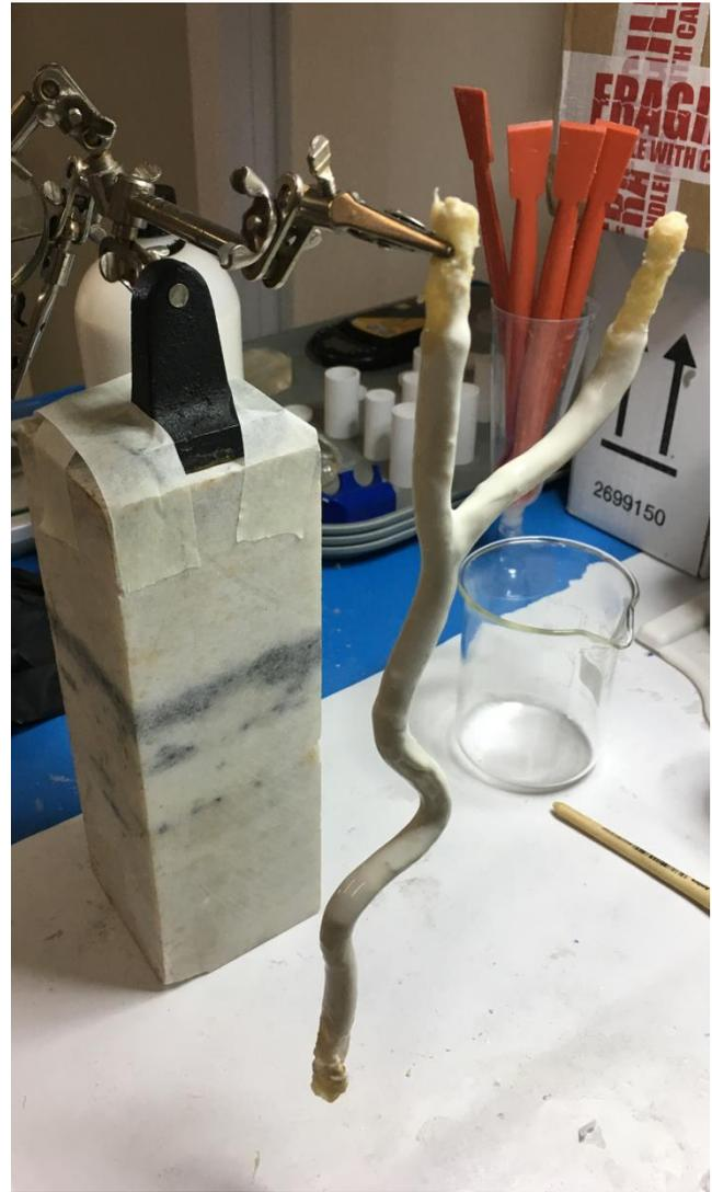
*Figura 5.12: provino appeso al supporto, prima da un'estremità e poi dall'altra per fare in modo che il lattice sia il più uniforme possibile*
