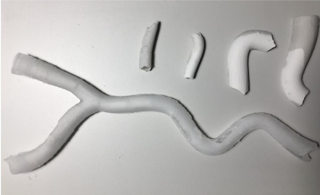
**Figura 5.19:** visualizzazione del risultato ottenuto, come si può vedere il provino in alcuni punti è stato estratto in maniera ottima, in altri il gesso ha assorbito il reticolante, in altri il materiale è penetrato all'interno del gesso
