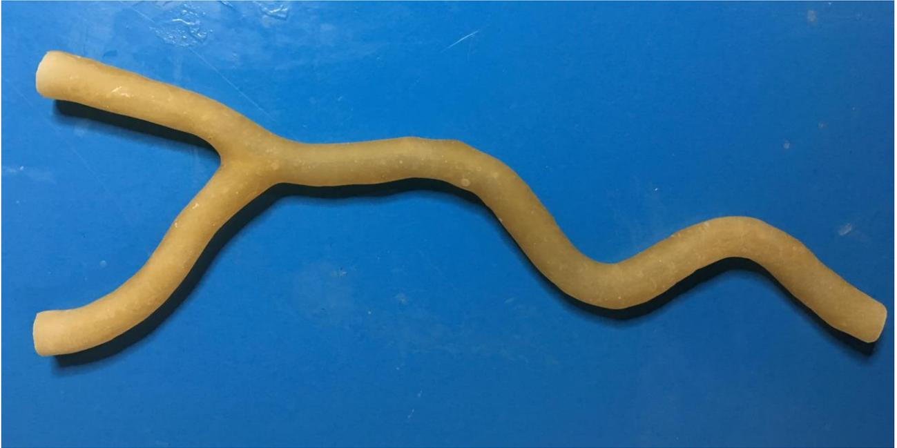
*Figura 5.15: modello in lattice della geometria semplificata*
