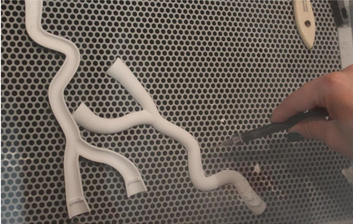
**Figura 5.6:** una volta estratti i provini vengono puliti con una sorta di mini compressore
