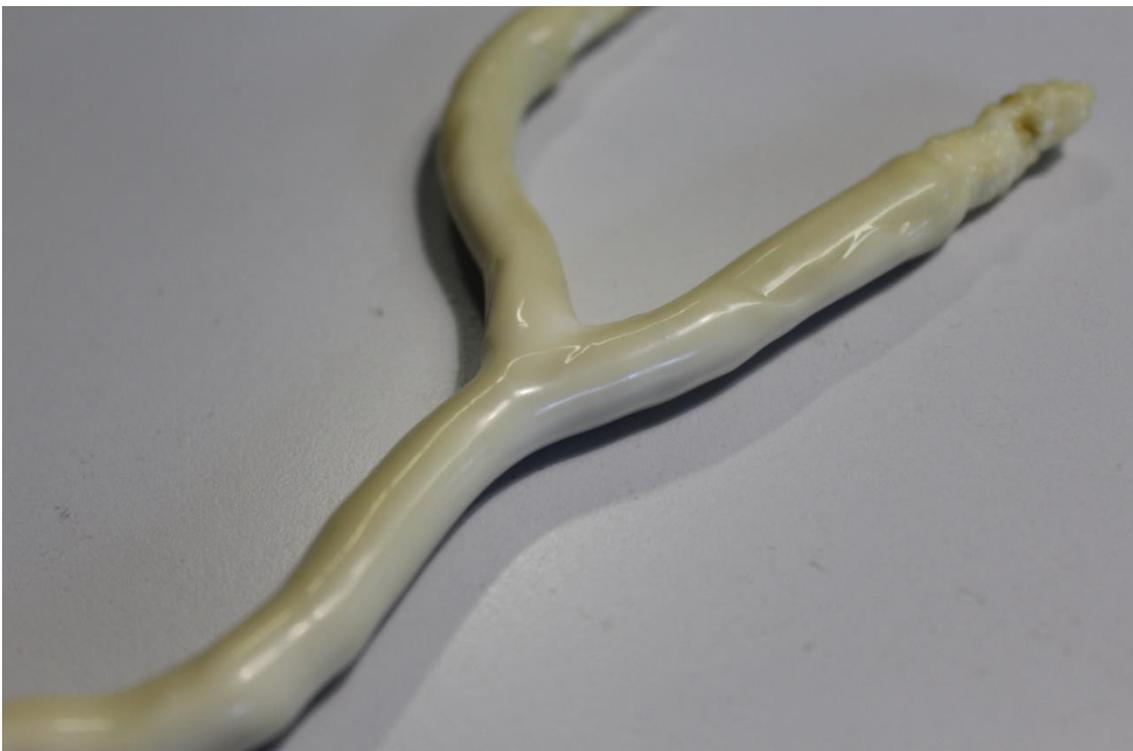
**Figura 5.14:** zoom sul provino per visualizzare maggiormente la consistenza del lattice asciutto
