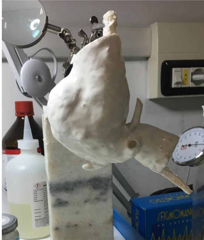
**Figura 7.17:** modello del tratto addominale dell'aorta interessato dall' aneurisma, il modello è stato immerso nel lattice e lasciato ad asciugare
