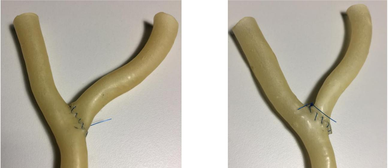
**Figura 7.11:** modelli dopo il test di sutura effettuato dal chirurgo, a sinistra il modello con 4 immersioni risultato il migliore, a destra il modello con 3 immersioni.
