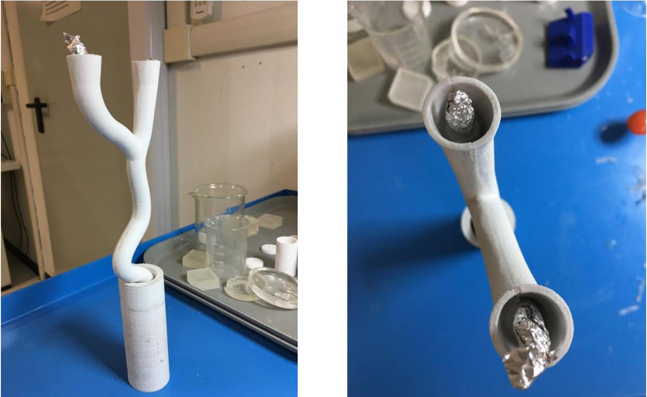
**Figura 5.18:** provino dopo la colatura del Sylgard, a sinistra visualizzazione intera su un supporto che gli permette di stare in verticale, a destra visualizzazione dall'alto delle estremità dove è stato colato il materiale
