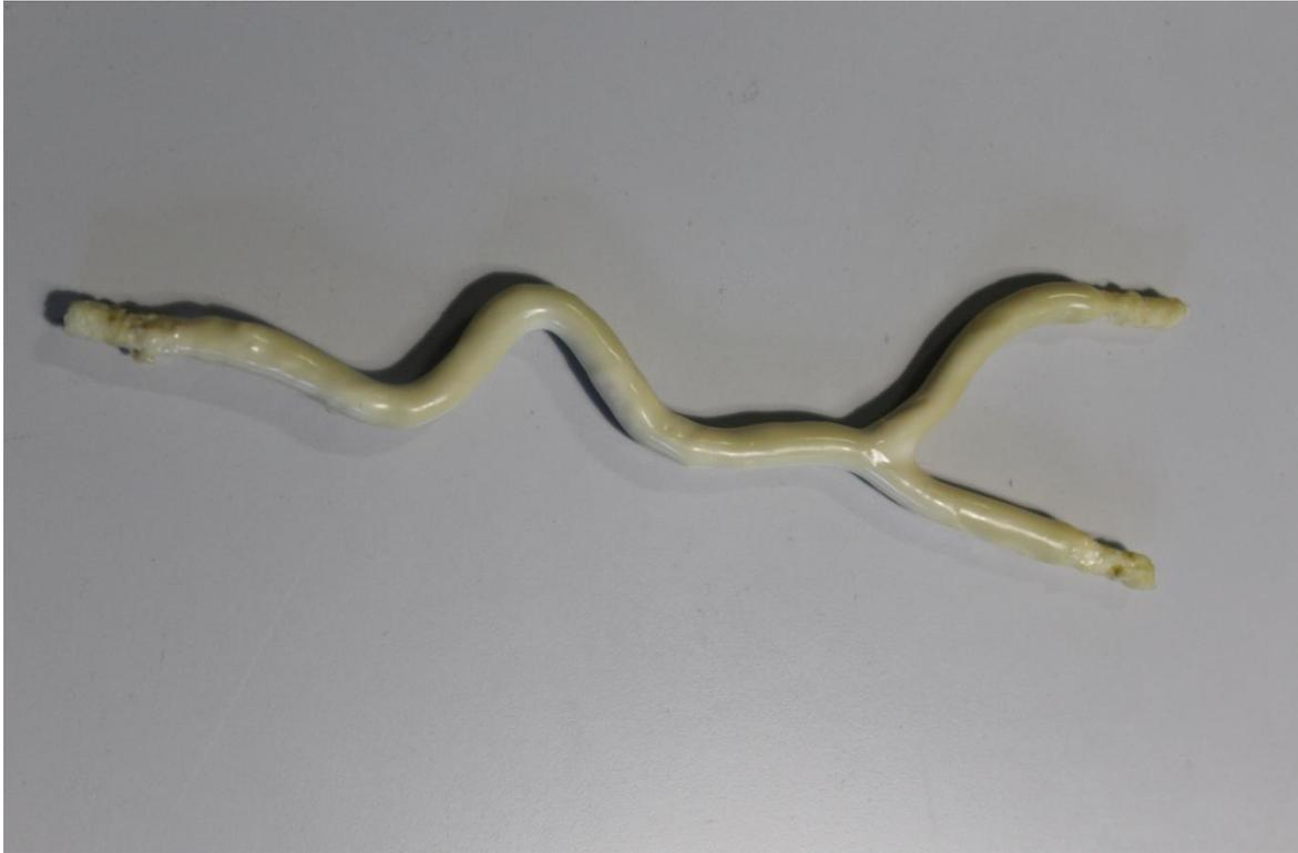
**Figura 5.13:** visualizzazione della geometria semplificata immersa 5 volte nel lattice prima della rimozione dell'anima interna.
