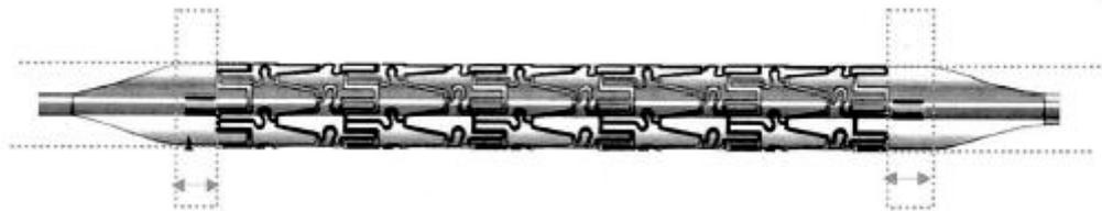
**Figura 2.3** Stent metallico: si noti la struttura a maglie e links
